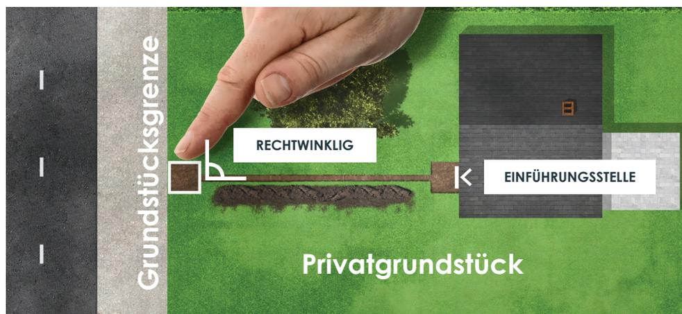
Ein Schacht von **1 m x 1 m** an der Oberfläche und **1,2 m** Tiefe ist außerdem an der Stelle auszugraben, wo der Anschluss ins Gebäude eingeführt wird, damit unsere Techniker die Kabel und/oder Leitungen einfach handhaben können. Er dient außerdem dazu, die von außen kommenden Rohrleitungen zu unterbrechen, um das Eindringen von Feuchtigkeit oder Gas ins Gebäude zu vermeiden.
