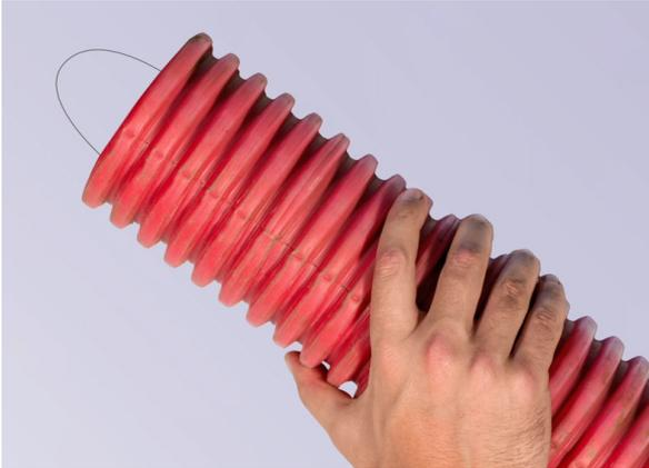
Une gaine d'attente doit être placée par vos soins dans le fond de la tranchée, c'est-à-dire à **60 cm** de profondeur, depuis l'intérieur du bâtiment jusqu'en limite de propriété. Il faut prendre soin d'éviter les angles droits et de respecter les distances avec les gaines qui serviront aux autres raccordements.
